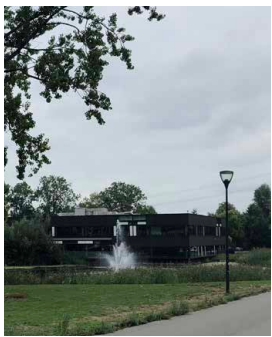
BESTAANDE LICHTMAST GERECYCLED KLEUR: GEPOEDERCOAT ANTHRACITE / KLEUR: RAL 7016 LEVERANCIER: GEMENTE LIDEN LICHTSTERKE: 3000 KELVIN
