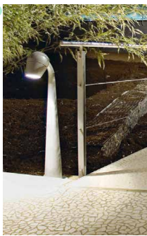
LICHTMAST (OLIVIO POLLER MEDIO) AFM: Ø220MM, LICHTPUNTHOOGTE 1000MM LEVERANCIER SELUX / TYPE: SX 970 T4-9 / INCL DIM REGIME / 2700 KELVIN
