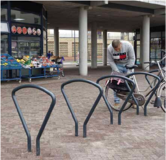
DE CLIP KLEUR RAL 7016 MET FUNDERING ONDER MARVELO AFM 70°/75CM | AFSTAND 90CM LEVERANCIER: STREETLIFE
